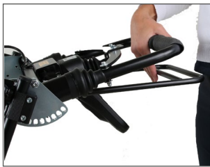
Vid körning med Z-styrning, greppa tag om stöd-/säkerhetsbågen
